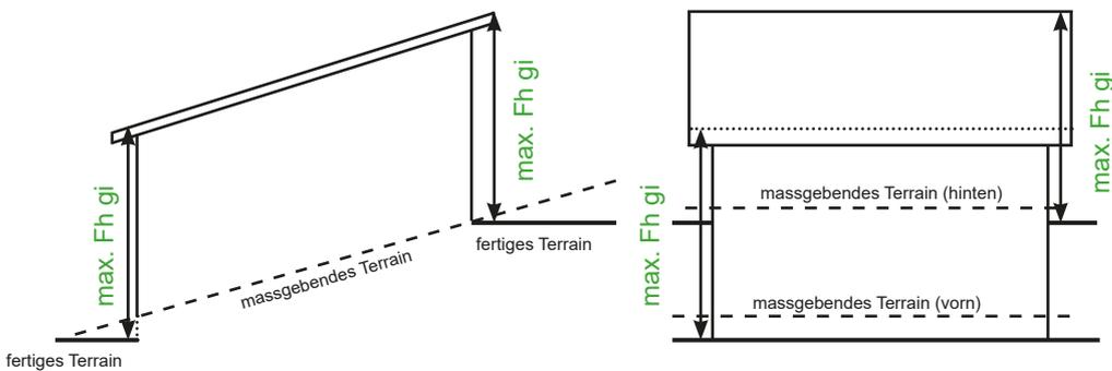
Bei Längs- und Quergefälle des massgebenden Terrains
