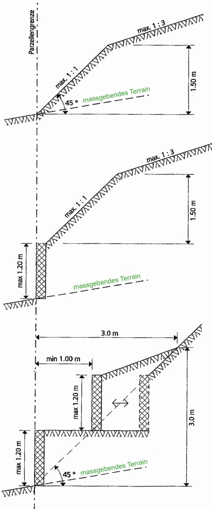
Stützmauern und befestigte Böschungen dürfen nicht höher als 1.20 m sein. Mehrere Stützmauern und Böschungen übereinander sind nur gestattet, wenn der horizontale Abstand mindestens 1,0 m beträgt. Die Stufen sind zu begrünen. Im weiteren gilt Art. 79 EG zum ZGB.
